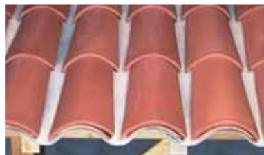
Mise en œuvre traditionnelle (1 tuile) en pose à "joints droits". Les tuiles Canal Gélis sont posées à recouvrement sur les sommets d'onde des plaques.
