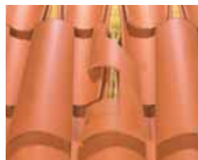
Fixation des tuiles de couvert en plain carré par crochets longs à œil cambré à raison, sur 10 crochets : 2 crochets longs à œil cambrés Réf. CRCAN.530
