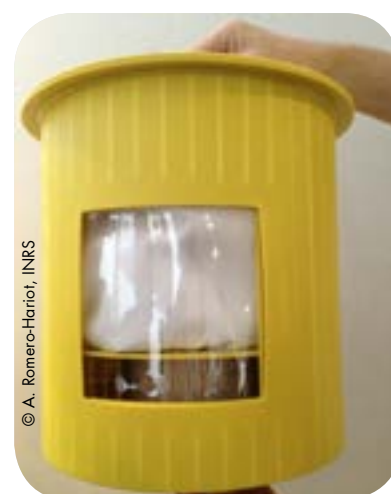
Cartouche filtrante à usage unique d'un aspirateur THE
