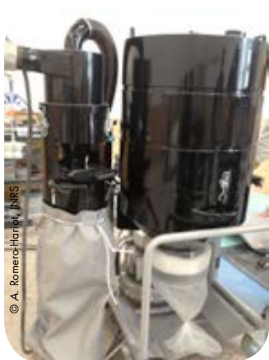
Aspirateur THE doté de système d'ensachage en continu
