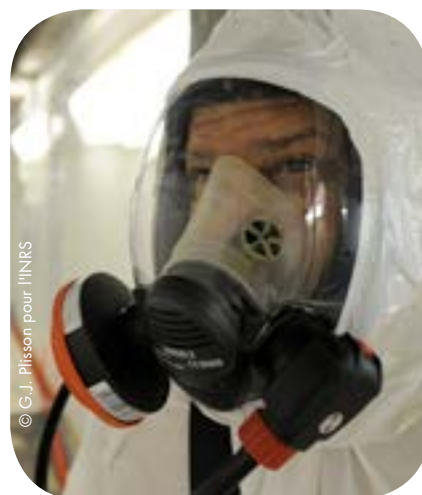
Appareil à adduction d'air comprimé
