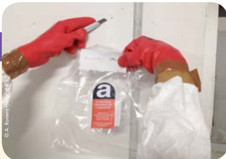
Prélèvement d'un échantillon de peinture susceptible d'être amiantée
