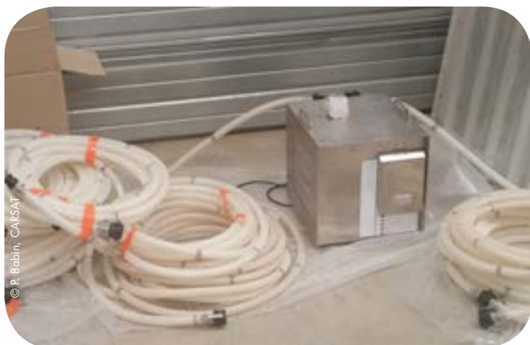
Dispositif de distribution d'air portatif
