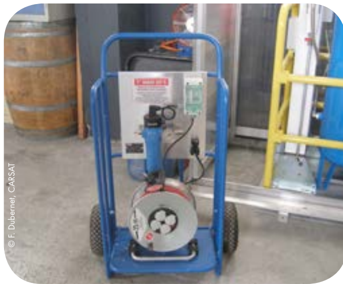
Dispositif de réchauffage de l'air respirable
