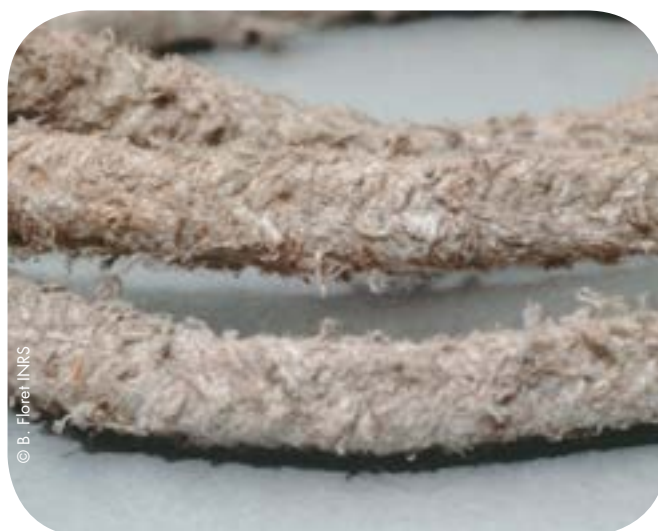
Joint tresse en amiante
