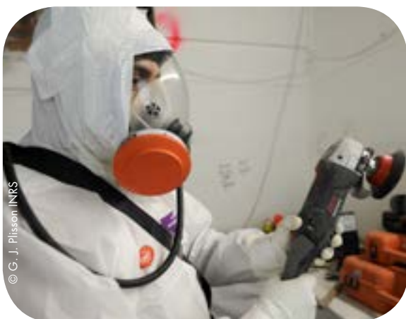
Ponceuse avec captage à la source intégré
